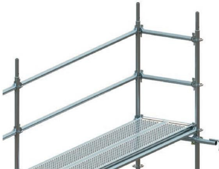
21. ábra Korlát (O-rúd) szerelése
