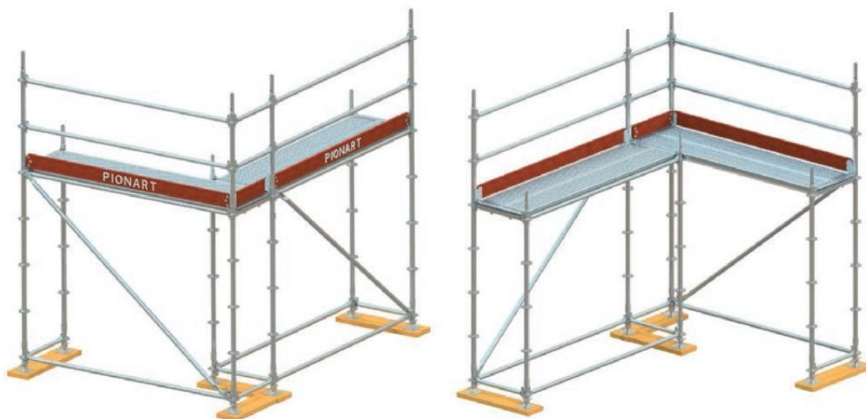
46. ábra Sarokegység 3 oszlopos rendszerrel
