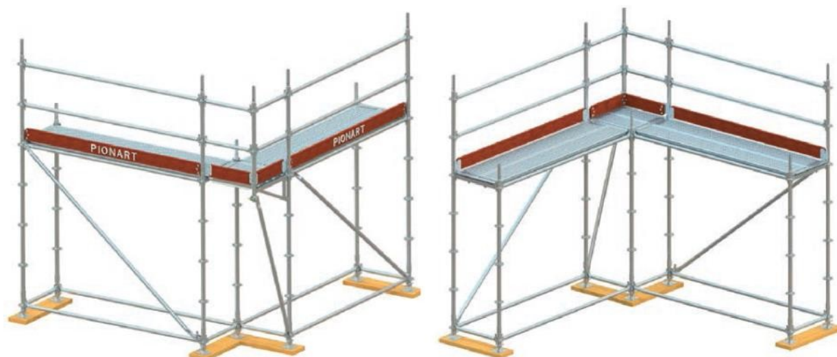
47. ábra Sarokegység 3 oszlopból és egy 0,73 m-es kinyúlásos konzolból álló rendszerből
