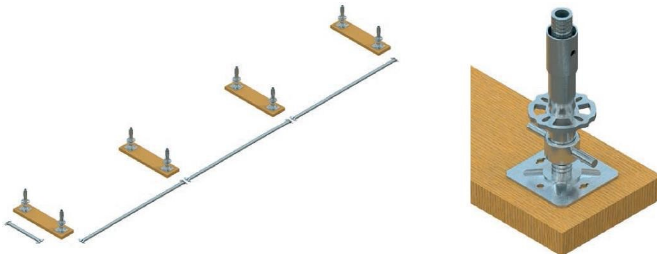
3. ábra Az állítható lábak elhelyezése rászertelt kezdőelemekkel
