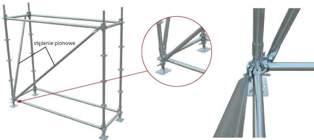
19. ábra A függőleges (átlós) merevítők szerelése
