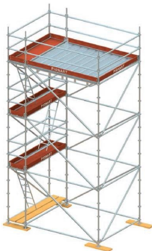
37. ábra Munkaállvány acél járólapokkal
