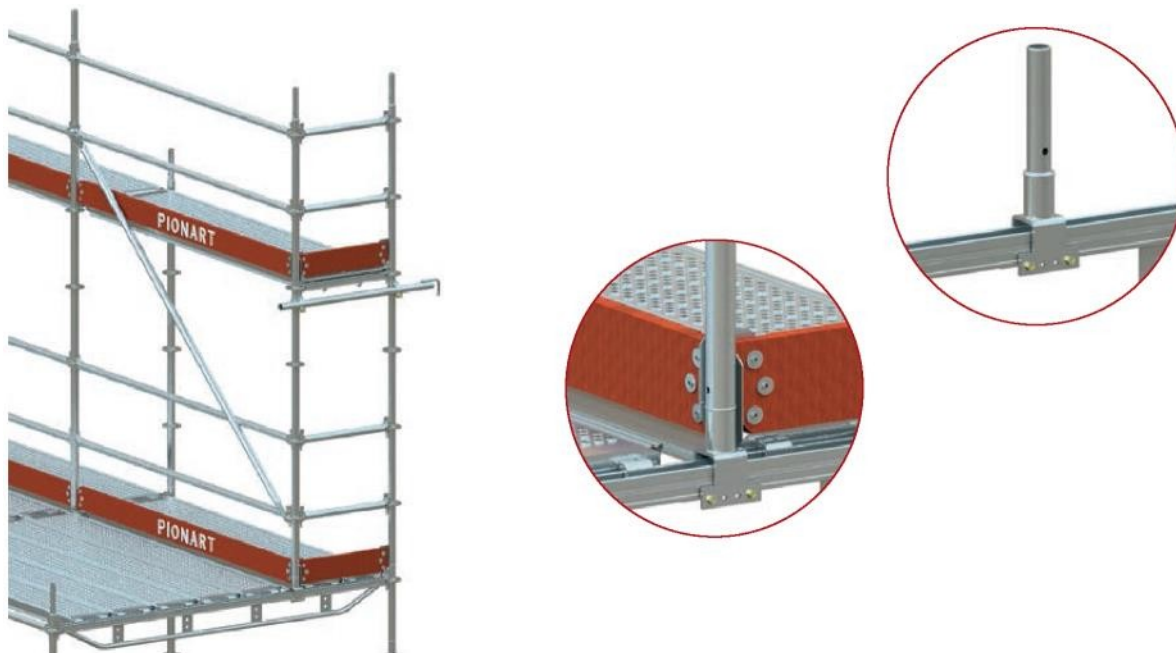
35. ábra A mező keskenyebbé tétele U-rudas csatlakozással
